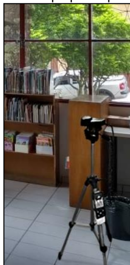
Figura 17 - Uso de tripé para apoio do luxímetro
